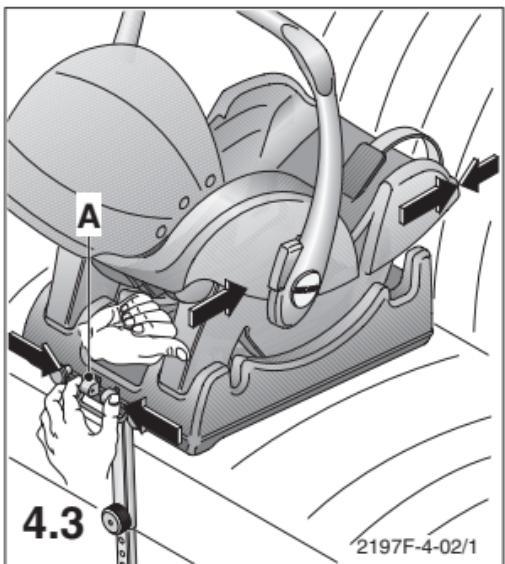
4.3 Drücken Sie die beiden grünen Knöpfe (A) um die Sperre für die erste Raste zu lösen. Danach können Sie das System ohne drücken der grünen Knöpfe nach hinten bis kurz vor das Fahrzeugpolster schieben.
