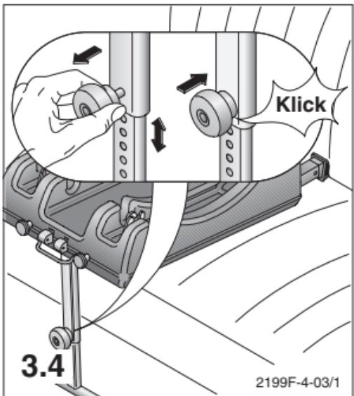
3.4 Réglage du pied support: Tirer le bouton de blocage et régler le pied support de sorte qu'il pose sur le sol du véhicule. Lâcher ensuite le bouton de blocage et veiller à ce que la partie inférieure du pied support soit enclenchée.
