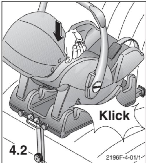
4.2 Spingere il seggiolino nell'ancoraggio anteriore fino allo scatto. Verificare che il seggiolino sia fissato correttamente davanti e dietro provando a sollevarlo.
