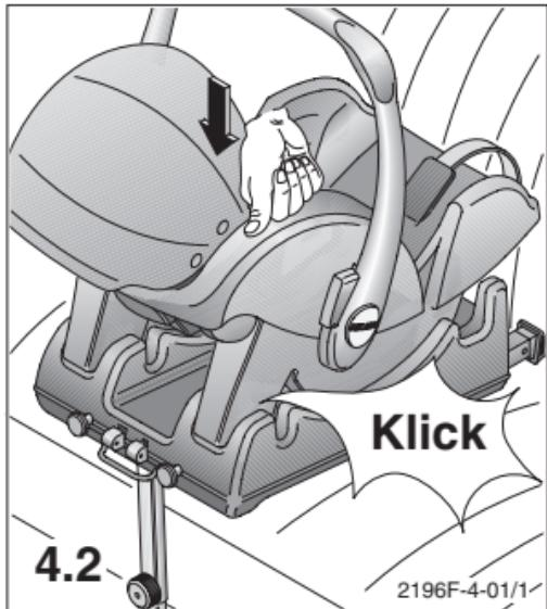
4.2 Encochez la coquille dans l'ancrage avant. En soulevant la coquille, vérifiez qu'elle est verrouillée à l'avant et à l'arrière.
