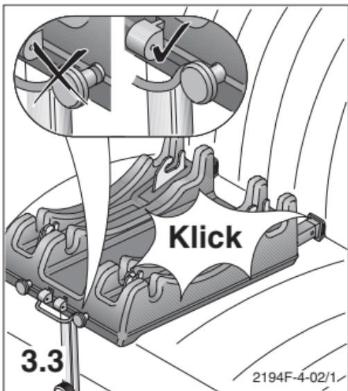
3.3 Rasten Sie die Isofixkontakte in die Isofixbügel ein. Die rote Markierung an den Entriegelungsknöpfen muss weg sein! Prüfen Sie die Verriegelung durch beidseitiges ziehen an der Plattform.
