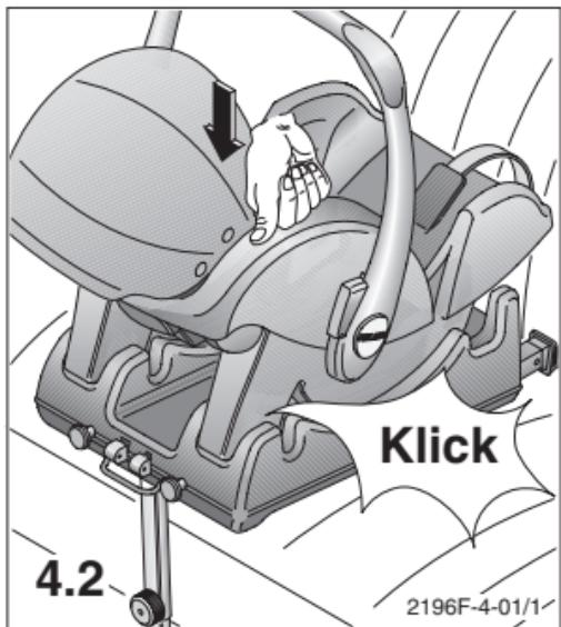
4.2 Rasten Sie die Schale in die vordere Verankerung ein. Prüfen Sie durch anheben, ob die Schale hinten und vorne eingerastet ist.
