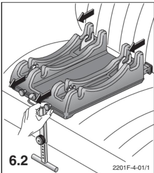
6.2 Lösen Sie die Isofixkonnektoren durch ziehen an den beiden Entriegelungsknöpfen.
