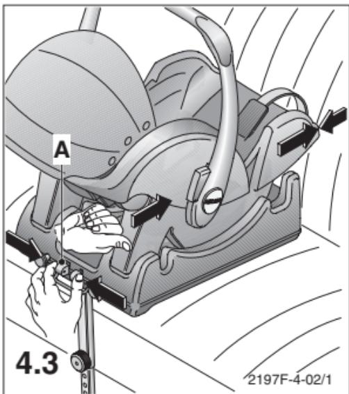
4.3 Appuyez sur les deux boutons verts (A) pour desserrer le verrouillage du premier cran. Ensuite, vous pouvez glisser le système en arrière, pratiquement jusqu'au rembourrage du véhicule, sans être obligé d'appuyer sur les boutons verts.
